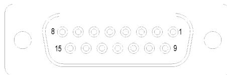
Abbildung 4: Pinbelegung AI/AO
